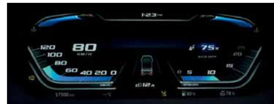
DAS HAUPTDISPLAY LÄSST SICH INDIVIDUELL AN DIE WÜNSCHE DES FAHRERS ANPASSEN
